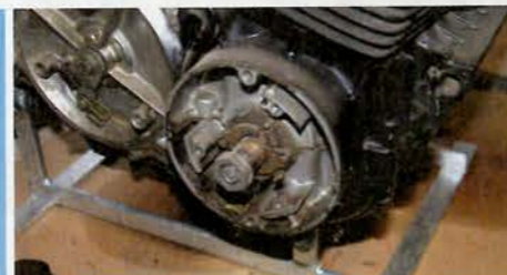
Vergleichsweise wartungsintensiv, aber ansonsten ein unauffälliger Arbeiter: die Kontaktzündung...
