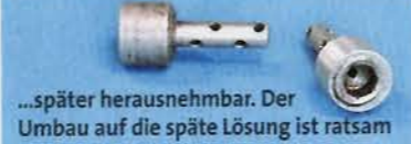
Drossel-Düsen regulieren den Ölfluß hoch zum Kopf. Zuerst waren sie fest verpresst...
