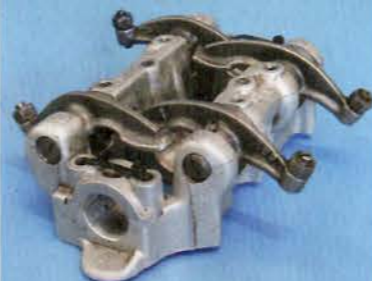
Die Schlepphebel der acht Ventile sind in den Nockenwellenböcken gelagert
