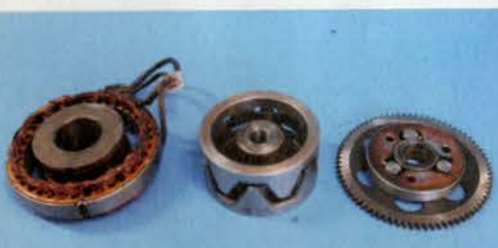
Links auf der Kurbelwelle untergebracht: die Lima, die sich wie fast alles als sehr robust erwiesen hat
