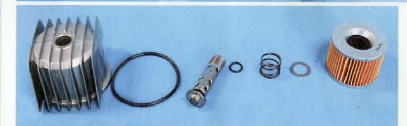
So soll es sein: Vom ersten Tag an hatte der Four-Motor eine Ölfilterpatrone im Hauptstrom. Europäische Hersteller setzten zum Teil noch auf grobe Drahtsiebe
