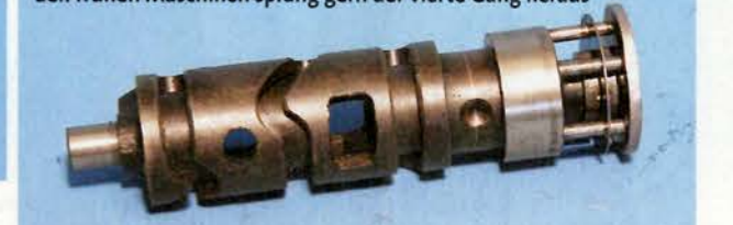
Nur bei der K0-Serie ein Problemfall: die Schaltwalze. Bei den frühen Maschinen sprang gern der vierte Gang heraus
