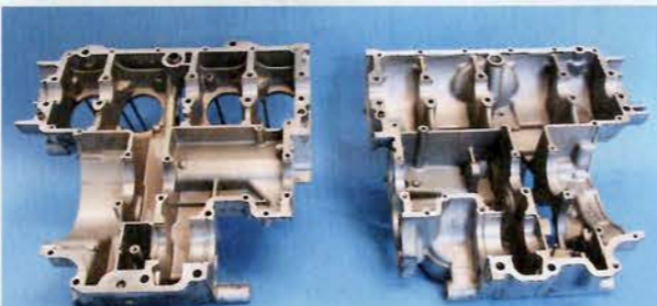
Des Motorschraubers Traum: Der horizontal geteilte Leichtmetall-Block erleichtert alle tieferen Eingriffe ins Triebwerk enorm
